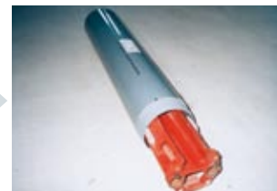
2 地上で埋設管内にケーシングをセットし、坑内に降下します。
