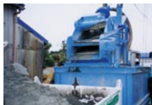
4 ユニット型泥水プラントで土砂と泥水を分離します。
